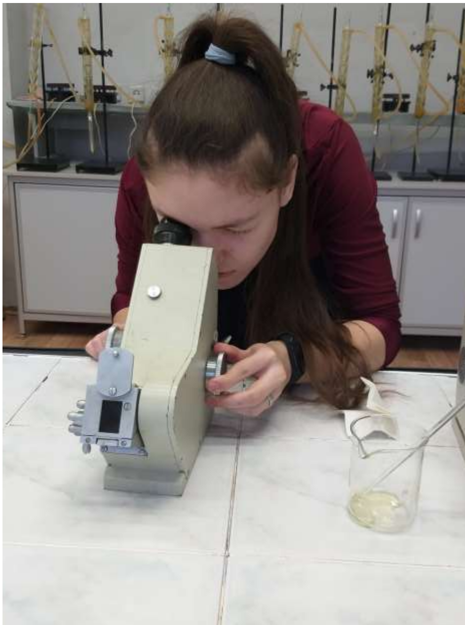
Рис. № 1. Определение влажности проб меда рефрактометрии
