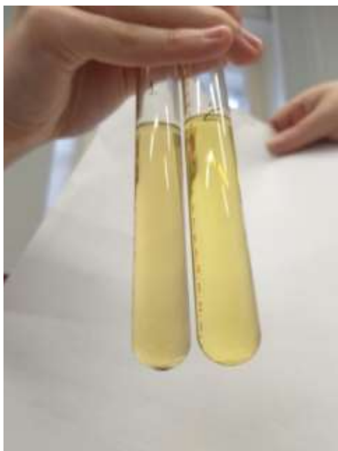
Рис. №3. Пробирки с опытом по определению диастазного числа.
