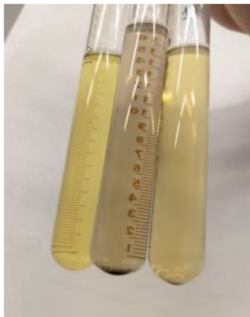
Рис. №3. Пробирки с опытом по определению диастазного числа.
